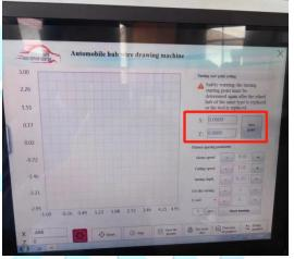
5. 如果刀尖扎到胶带里面。就需要人工用脉冲手轮后退 Z 轴到刀尖刚刚碰到胶带,然后点击电脑右上角的起点确认(zero point)按钮。左侧 X 轴 Z 轴坐标归零。然后正常操作开始车削。
